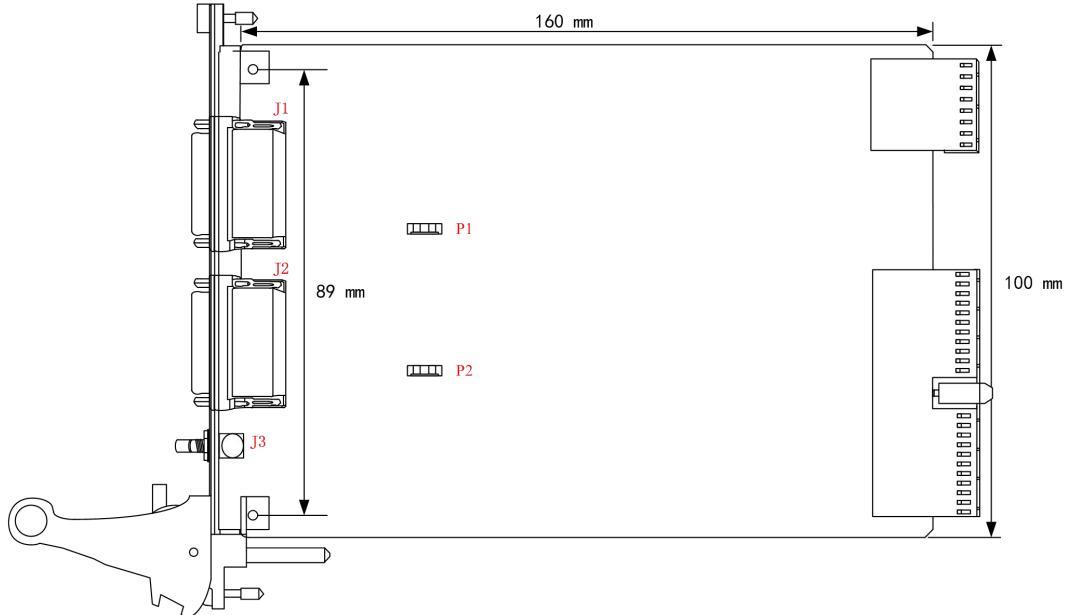
图 3-1-1 PXI4002 尺寸图
